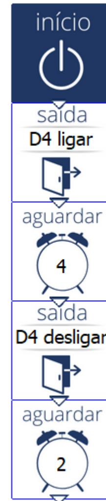
Vamos ativar um motor bldc utilizando um relê com auxilio de programação de blocos em Sucuri.
